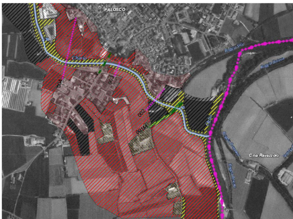
MAPPA DELLE SCABREZZE coefficiente n di Manning ( \text{sm}^{-1/3} ) e usi del suolo
